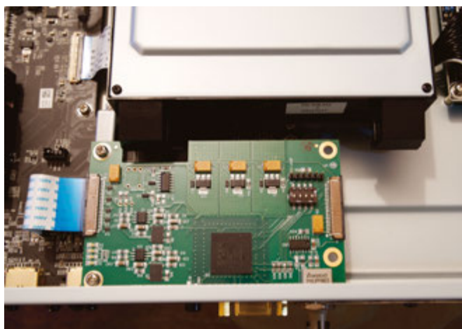
La scheda OpBox sostituisce, all'interno dell'Oppo BDP-103, la scheda DAC originale.
